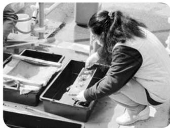
②第2塩化鉄に浸し、銅板表面を腐食させる
